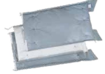
Bağlayıcısız imal edilen beyaz camyünü şilte ve silikonlu cam kumaşı kullanılarak, vanalar için özel üretilmiş yalıtım ceketidir. Kapalı ya da açık ortamlardaki DIN, ANSI, API standartlarında üretilmiş bütün vana (pistonlu, küresel, kelebek vana vb.) ve pislik tutucuların ısı yalıtımında kullanılır.
